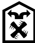
Вытяжка всасывает воздух, который очищается, проходя через жироулавливающие и угольный фильтры, а затем возвращается обратно в кухню.
